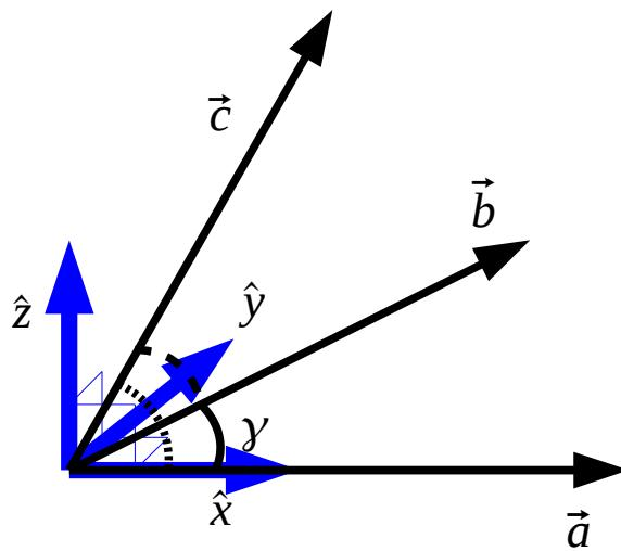
$$\begin{bmatrix} x_f \\ y_f \\ z_f \end{bmatrix} = \begin{bmatrix} x_a & y_a & z_a \\ 0 & y_b & z_b \\ 0 & 0 & z_c \end{bmatrix} \begin{bmatrix} x \\ y \\ z \end{bmatrix} \quad \begin{bmatrix} x \\ y \\ z \end{bmatrix} = \begin{bmatrix} a_x & b_x & c_x \\ 0 & b_y & c_y \\ 0 & 0 & c_z \end{bmatrix} \begin{bmatrix} x_f \\ y_f \\ z_f \end{bmatrix}$$
